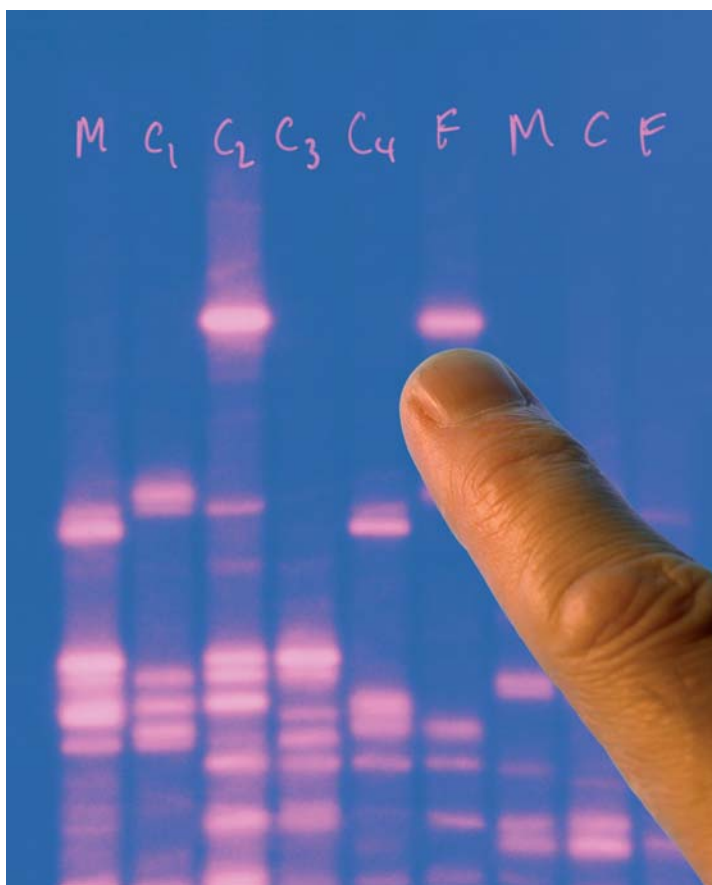
DNS-ujjlenyomat készítése, röntgenfilmes autoradiográfia
